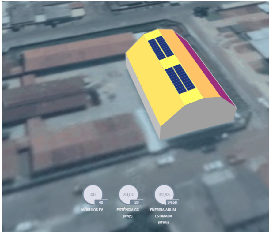
FIGURA 2 – ÁREA SUGERIDA PARA INSTALAÇÃO DO SISTEMA FV.
