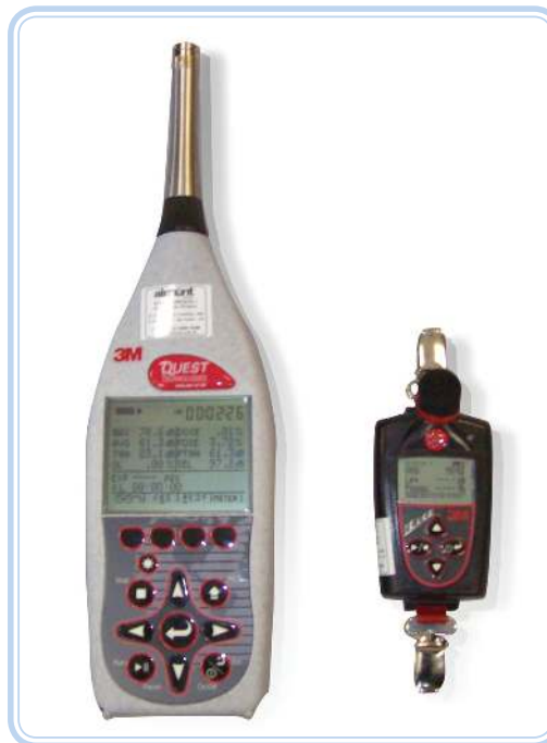
Figura 4.1: Medidor de nível de pressão sonora (decibelímetro) e dosímetro de ruído Fonte: CTISM
