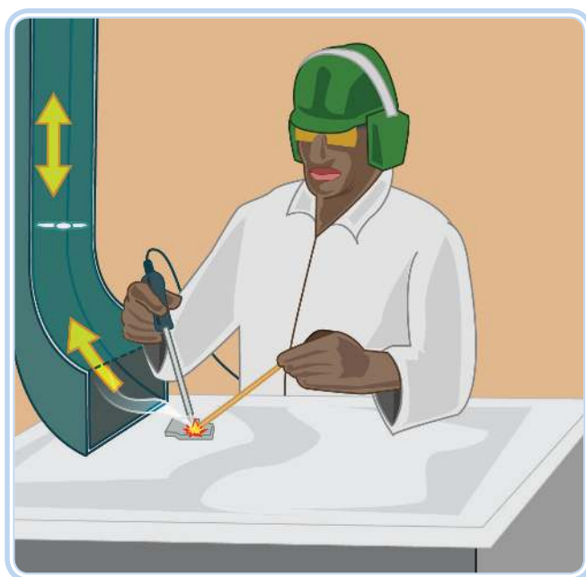
Figura 1.6: Controle: ventilação local exaustora de processo
