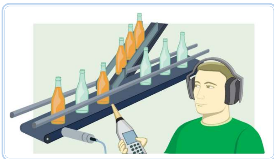
Figura 3.4: Avaliação do ruído com decibelímetro
