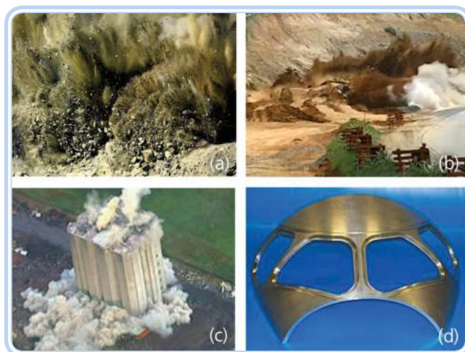
Figura 2.1: Explosão em pedreira (a), explosão em obra de rodovia (b), implosão de prédio (c) e cabine de avião conformada por explosão (d)
