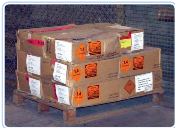
Figura 4.17: Carga fracionada identificada
