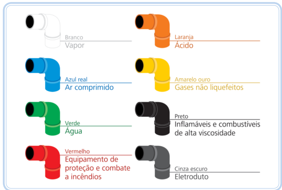
Figura 3.4: Identificação de cores para tubulações
