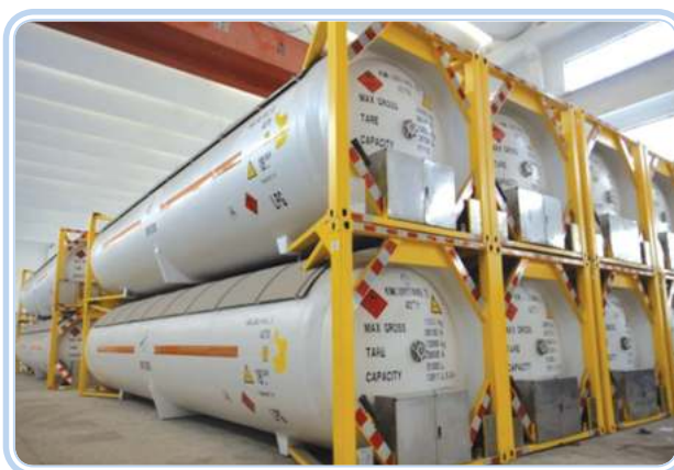
Figura 6.14: Contêineres tanque sinalizados
