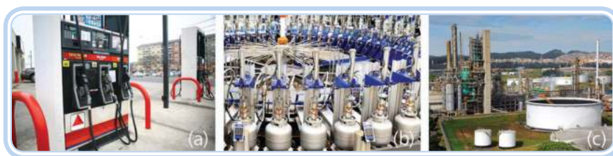
Figura 3.1: Instalação classe 1 – posto de serviço de combustíveis (a), instalação classe 2 – engarrafadora de gás inflamável (b) e instalação classe 3 – refinaria (c)
